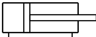
LOHSE pneumatiske cylindre VMV er cylindre med justerbar slaglængdebegrænsning over hele slaglængden.
