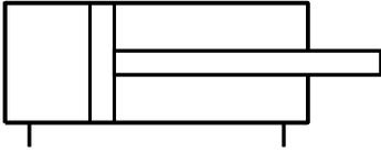
LOHSE-Pneumatikzylinder PZ haben in Schließrichtung einen Festanschlag - Stellmutter entfällt - und sind in Öffnungsrichtung über die Stellschraube im Hub justierbar.
